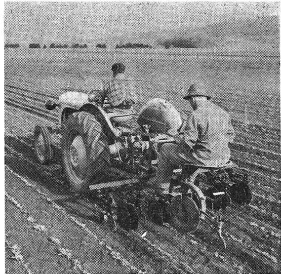
Et voici l'instrument universel porté avec conduite de précision et roulette de direction sous le siège du servent.
