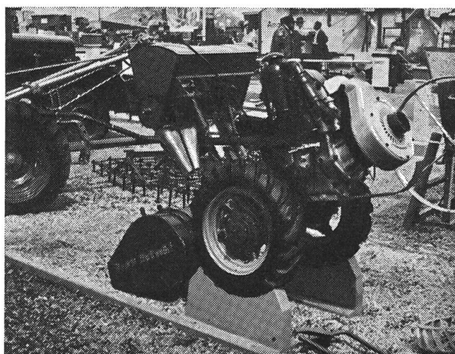
Fig. 1: Epandeur d'engrais Tauch, avec siège. Il est possible de fixer des éléments de herse devant et derrière la trémie.
