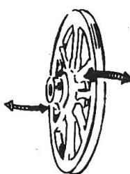
En faisant osciller la roue de droite et de gauche, contrôler s'il y a du jeu radial. L'éliminer soit en changeant la fourrure de moyeu, soit en revêtant la fusée d'une douille de fer-blanc ou d'un tronçon de tube approprié.
