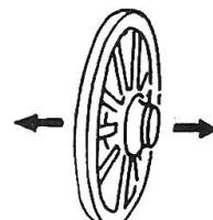
En tirant et poussant la roue horizontalement, contrôler s'il y a du jeu axial. L'éliminer soit en procédant à un réajustage, soit en posant des rondelles.
