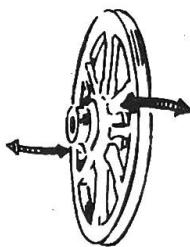
En faisant osciller la roue de droite et de gauche, contrôler s'il y a du jeu radial. L'éliminer soit en changeant la fourrure de moyeu, soit en revêtant la fusée d'une douille de fer-blanc ou d'un tronçon de tube approprié.
