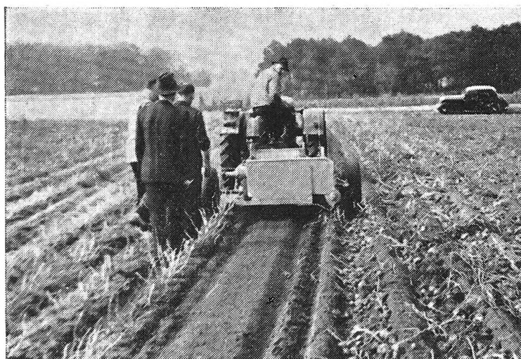
Fig. 3: Arracheuse-aligneuse Wisent à chaîne cribleuse, vue au travail.
