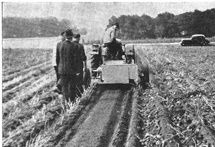
Fig. 3: Arracheuse-aligneuse Wisent à chaîne cribleuse, vue au travail.
