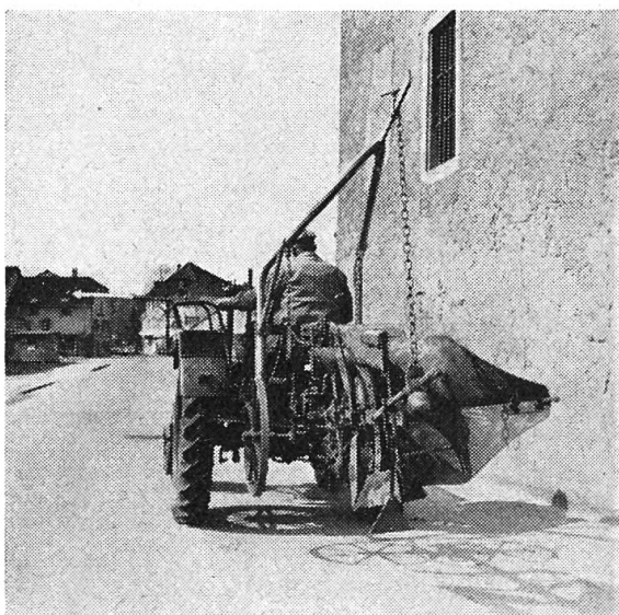
Fig. 15: Exemple d'un tracteur avec charrue convenablement signalé. Le triangle réfléchissant est fixé par un crochet. On observera en outre que le conducteur de tracteur fait connaître son intention de bifurquer en utilisant un bâton de signalisation rouge et blanc.
