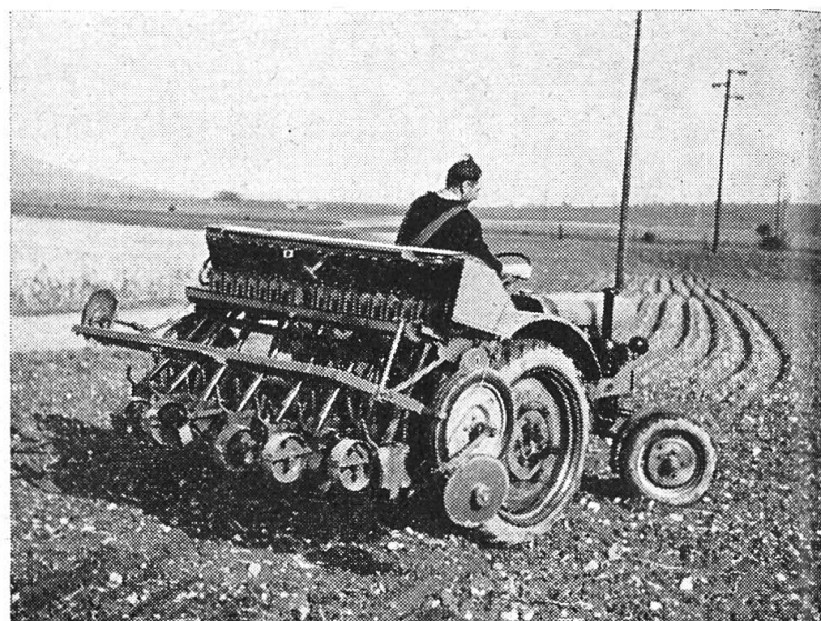
Fig. 1: Butteuse semi-portée à pommes de terre. — La roulette-support sert à régler la profondeur de travail.
