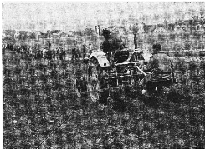
15 et 16 Instrument universel Aebi effectuant le creusage des trous de plantation puis le recouvrement.
