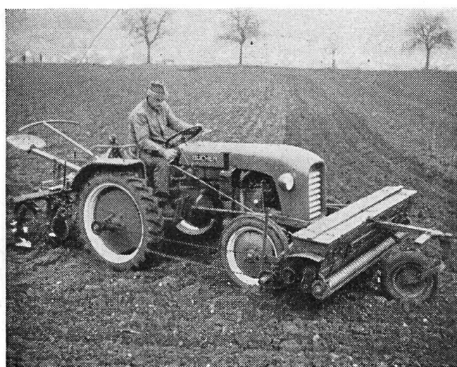
15 et 16 Instrument universel Aebi effectuant le creusage des trous de plantation puis le recouvrement.
