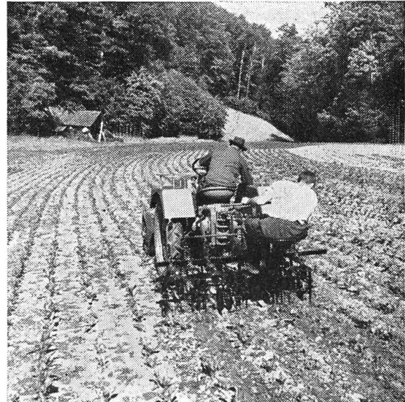
Le système de direction de l'instrument est indispensable pour un sarclage précis des betteraves.
