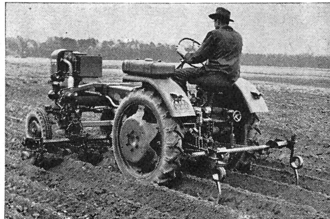
Fig. 9: Multitrac Güldner équipé d'un moteur Güldner de 17 CV. Le cadre a été allongé pour le montage entre les essieux de l'arracheuse de pommes de terre Dettmann.
