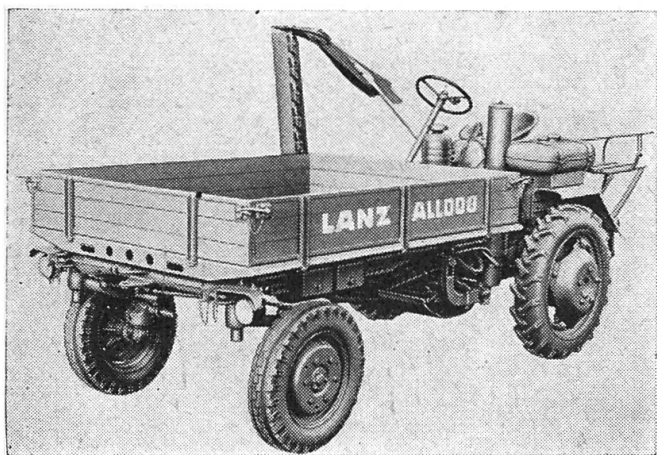
Fig. 7: Cadre porte-outils Lanz (Alldog) équipé d'un appareil faucheur et d'un caisson de transport.
