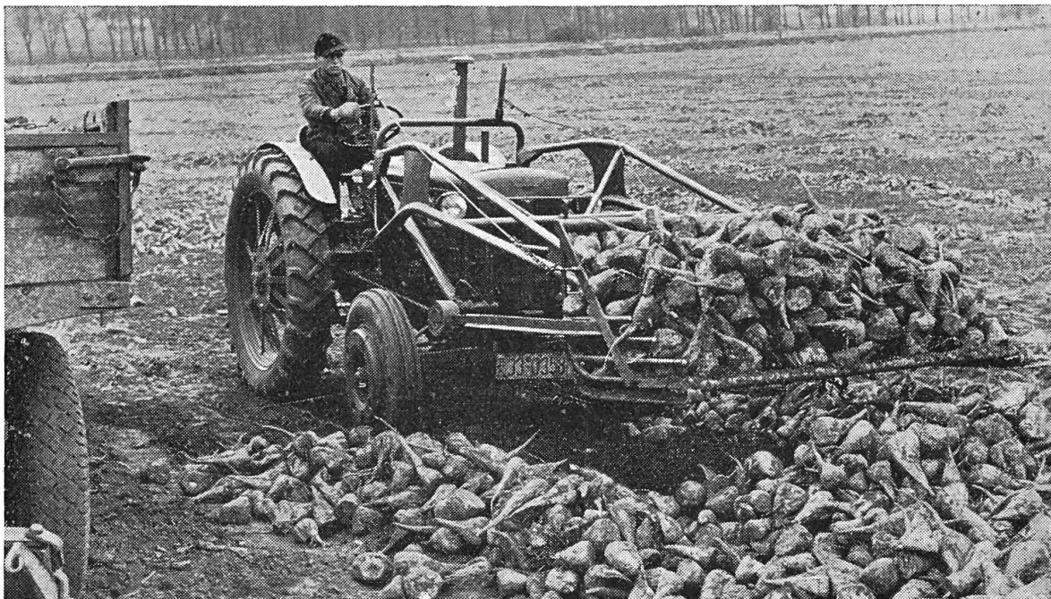
Elévateur frontal utilisé pour charger les betteraves déjà mises en tas.
