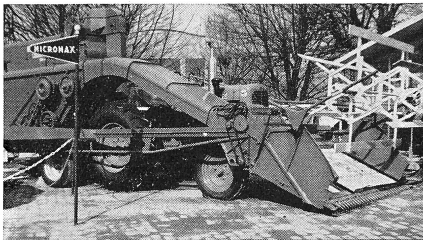
2 Moissonneuse-batteuse Dhotel avec tracteur «incorporé».
