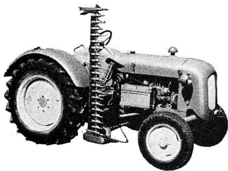
Le nouveau tracteur **Vogel-Diesel** va de succès en succès, et il le mérite. Car il n'y en a pas de plus robuste. Moteur Ford Diesel, 18/45 ch, 1900 kg. Braquage facile et court. Voie réglable. Bloquage différentiel, freins tambours formidables. Vite lente, pour ensileur ou moissonneuse - batteuse. Possibilité de monter tous les accessoires. Demander offre et démonstration.
