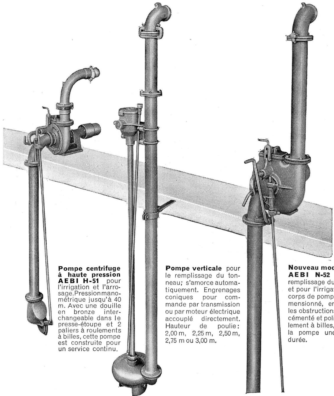
**Pompe centrifuge à haute pression AEBI H-51** pour l'irrigation et l'arrosage. Pression manométrique jusqu'à 40 m. Avec une douille en bronze interchangeable dans le presse-étoupe et 2 paliers à roulements à billes, cette pompe est construite pour un service continu.
