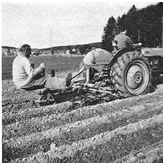
Instrument universel «Kombi» employé pour le sarclage (sans dispositif d'auto-direction)
