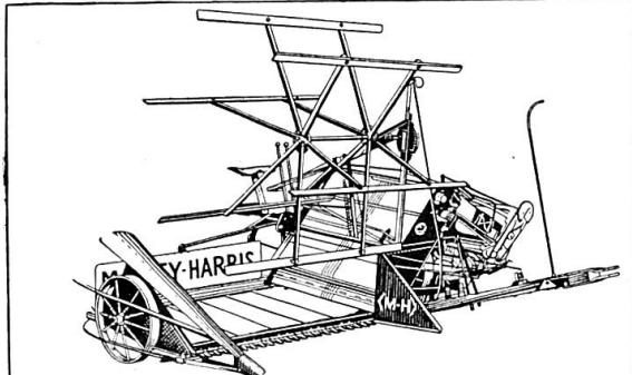
**LIEUSE COMBINÉE**, prise directe à tracteur ou traction animale alternativement possibles. Construction robuste. Mécanismes montés sur roulements à billes ou coussinets à rouleaux de précision. Largeur de coupe 1,50 m ou 1,80 m.
