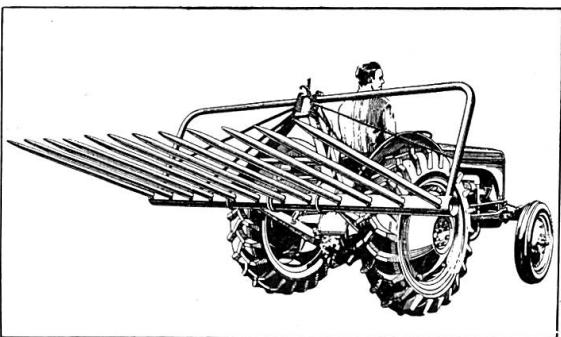
**RATEAU CHARGEUR** pour herbe ou foin. Outil spécialement conçu pour l'ensilage de l'herbe. Fixation facile aux 3 points. Déchargement à bascule. Largeur de travail 2,50 m, 12 dents de 1,20 m de longueur, hauteur du bâti 77,5 cm.
