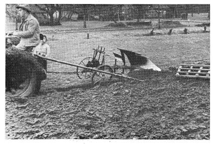
**Appréciation générale:** Le bras d'attelage «Baumann» pour herse à tracteur permet d'effectuer le labourage et le hersage en un seul passage. La construction est simple et solide. Ce dispositif convient pour les petites exploitations où l'on utilise une charrue Brabant et pour lesquelles l'acquisition d'une herse soit roulante, soit entraînée par la prise de mouvement, ne peut entrer en considération pour des raisons financières.
