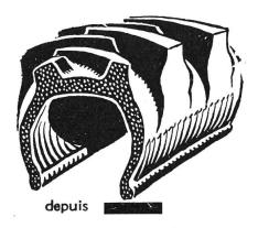
**Description:** Dans le cas du pneu de tracteur «Vacu-Lug», il s'agit d'une carcasse usée, encore en bon état, avec barrettes vulcanisées. Lors de la rénovation, le profil original est, en règle générale, reconstitué. Les pneus regommés ont un profil plus haut et plus large.
