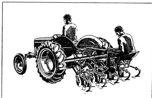
**Cultivateur manœuvrable**, dents avec disques, couteaux et pattes d'oie réglables facilement, s'emploie avec 1 auxiliaire, pour travail sur 4 lignes (outil spécialement conçu pour cultures de betteraves).
