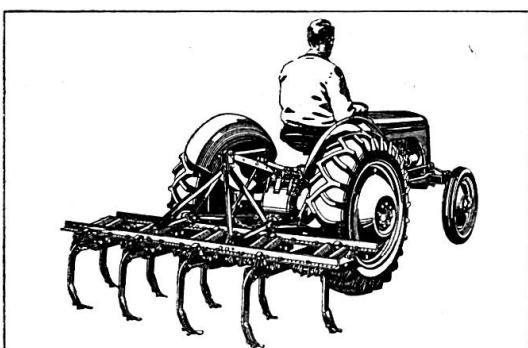
**Cultivateur Tiller**, 9 dents escamotables à ressort permettant travail dans terres les plus difficiles. Soc réversible type lame ou patte d'oie. Largeur de travail 1.86 m, profondeur 23 cm.
