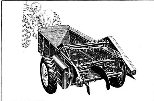
**Epandeur à fumier**, actionné par les roues avec nouveau mécanisme de distribution efficace. Contenance 2 m<sup>3</sup>.
