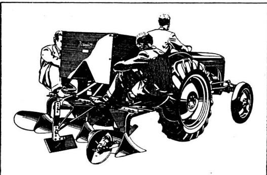
**Instrument pour le plaçage de betteraves** sur 4 ou 6 rangs. Etoiles à couteaux à suspension individuelle. Echange des couteaux facile.
