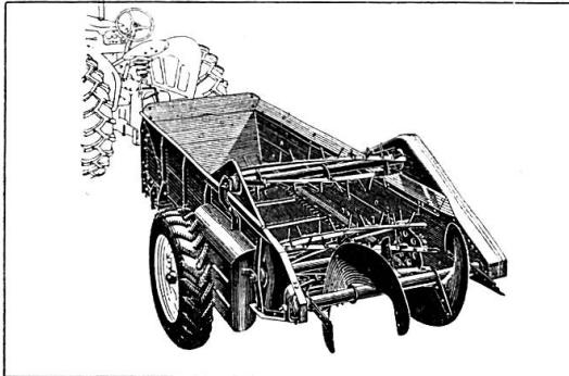
**Épandeur à fumier**, actionné par les roues avec nouveau mécanisme de distribution efficace. Contenance 2 m<sup>3</sup>.
