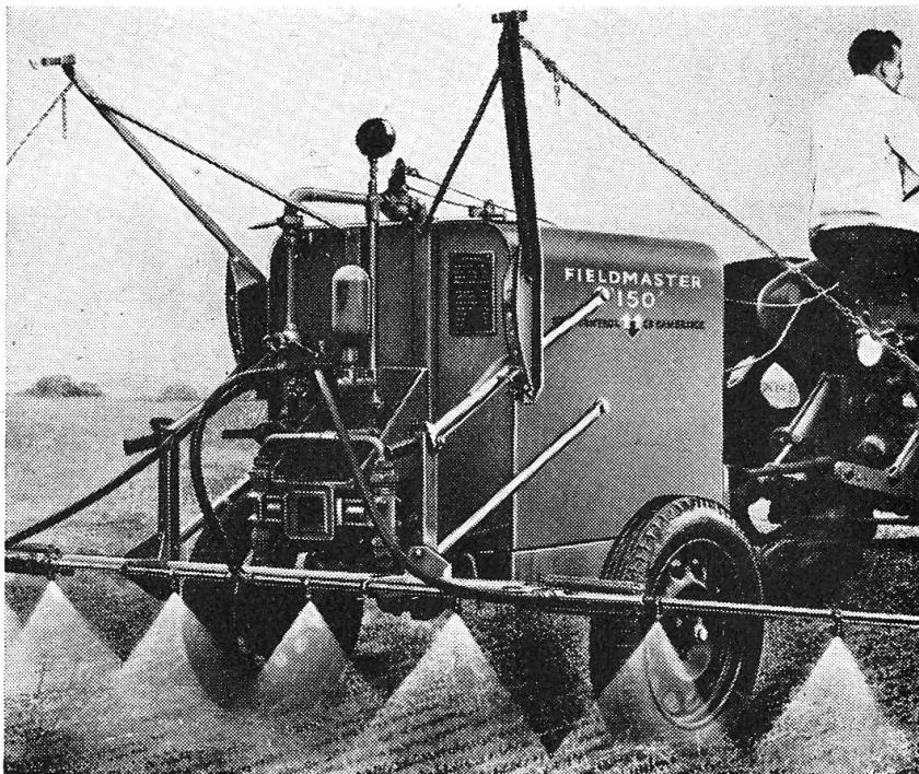
Le nouveau pulvérisateur tracté «Fieldmaster 150». Il pulvérise de 70 à 1200 lit. par ha. Le réservoir a une contenance de 680 lit. Largeur de travail: 7,30 m. Actionnement par la prise de force.
