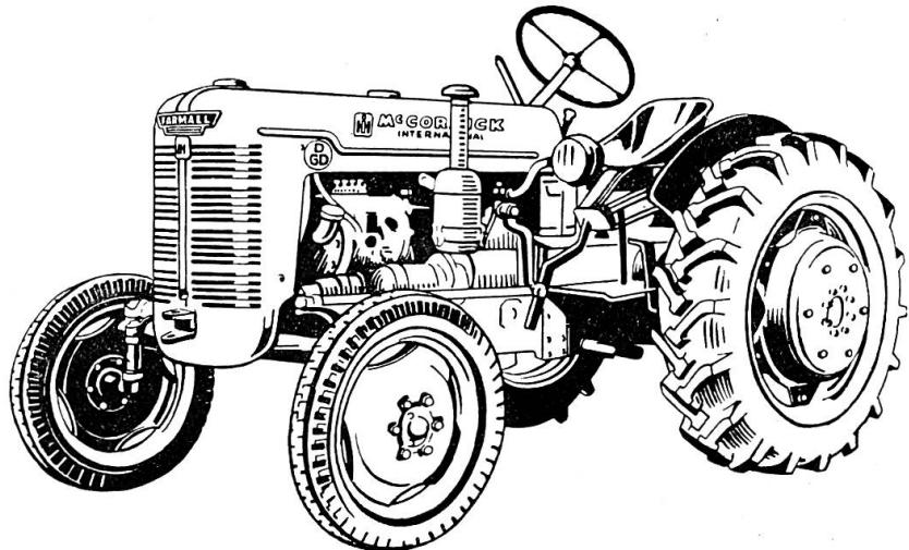
Les nouveaux **tracteurs Diesel pour tous usages, types DED et DGD**, sont très maniables dans les champs, rapides sur la route. C'est presque sans perte d'énergie que leur boîte de précision IH à 5 vitesses assure la transmission de puissance sur les roues arrière, d'où l'étonnante capacité de traction de ces véhicules.
