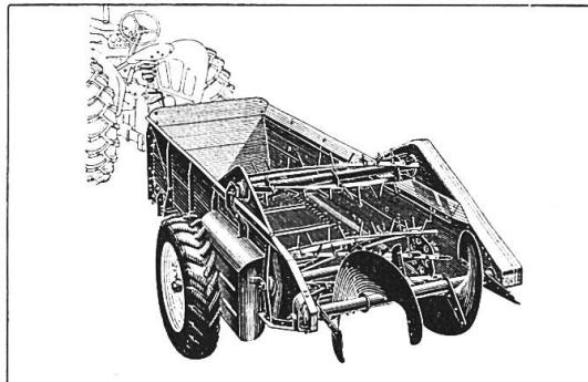
**Epandeur à Fumier**, actionné par les roues avec nouveau mécanisme de distribution efficace. Contenance 2 m<sup>3</sup>.
