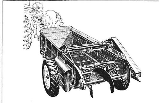
**Épandeur à Fumier**, actionné par les roues avec nouveau mécanisme de distribution efficace. Contenance 2 m<sup>3</sup>.
