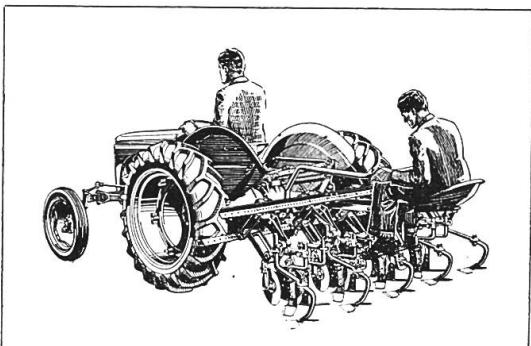
**Cultivateur Manœuvrable**, dents avec disques, couteaux et pattes d'oie réglables facilement, s'emploie avec 1 auxiliaire, pour travail sur 4 lignes (outil spécialement conçu pour culture de betteraves).
