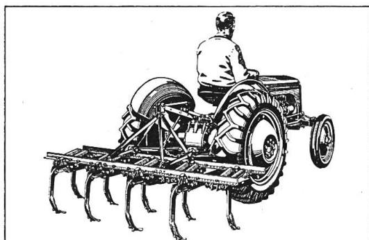
**Cultivateur Tiller**, 9 dents escamotables à ressort permettant travail dans terres les plus difficiles. Soc réversible type lame ou patte d'oie. Largeur de travail 1.86 m, profondeur 23 cm.
