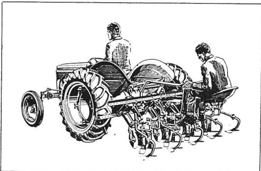
**Cultivateur Manœuvrable**, dents avec disques, couteaux et pattes d'oie réglables facilement, s'emploie avec 1 auxiliaire, pour travail sur 4 lignes (outil spécialement conçu pour culture de betteraves).
