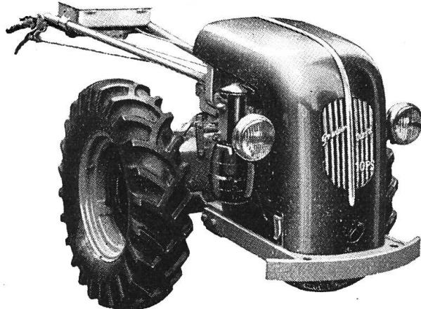
**Vitesses:** 3 marches AV (4 / 6,7 / 12,5 km/h), 1 marche AR (2,5 km/h), avec blocage de différentiel et déclabotage individuel des roues.
