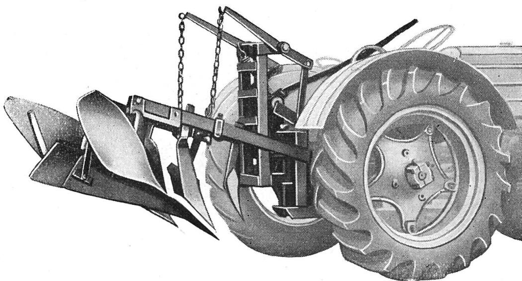
Modèle spécial à goupille de cisaillement avec relevage mécanique à bras.
