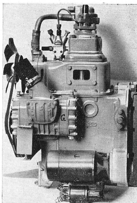
Moteur Diesel à 4 temps avec refroidissement par air, de la fabrique Klöckner-Humbert-Deutz S.A., Cologne (Allemagne).
