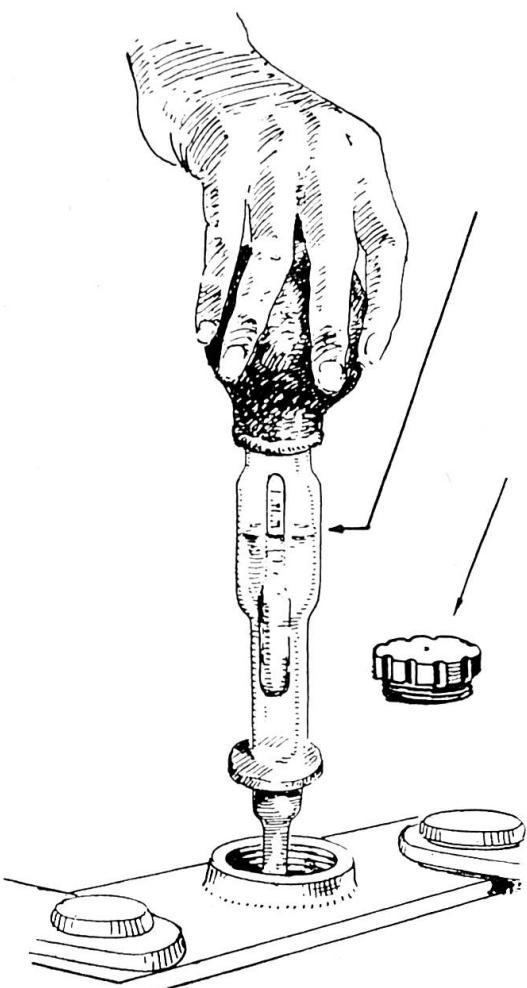
Si la quantité d'acide sulfurique a diminué, n'ajoutez **que de l'eau distillée** pour compenser ! Utilisez un récipient et un entonnoir tout-à-fait propres.
