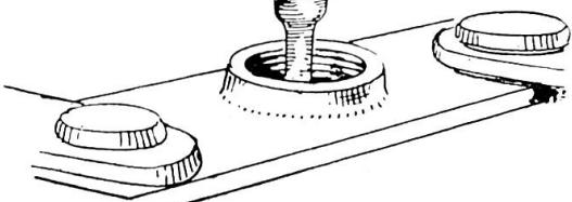
Si la quantité d'acide sulfurique a diminué, n'ajoutez **que de l'eau distillée** pour compenser ! Utilisez un récipient et un entonnoir tout-à-fait propres.
