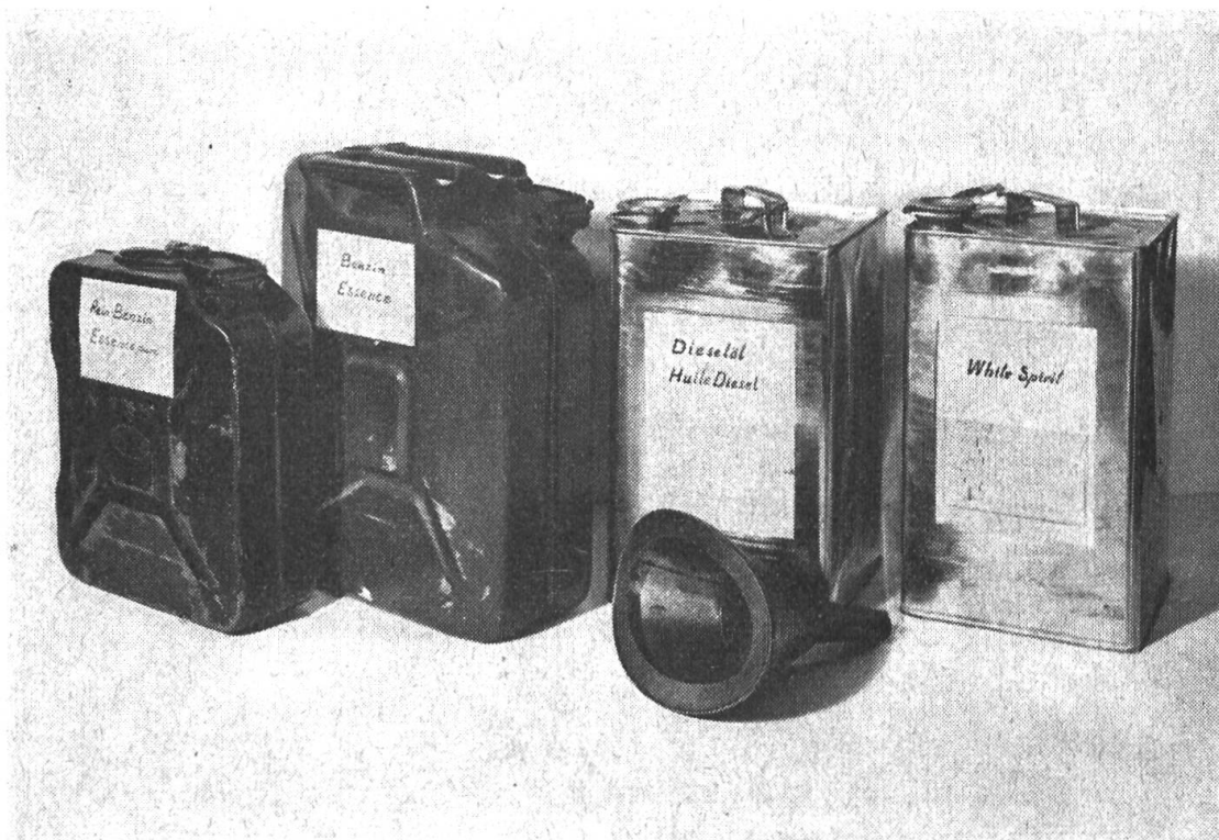
Fig. 5: Provision journalière de carburant: Il est à conseiller d'avoir à disposition de telles réserves, prêtes à l'emploi, que l'on préparera dès que le plein de carburant aura été fait. On évitera ainsi de devoir toujours être autour des fûts. Les bidons doivent être pourvus d'une étiquette ou diversement coloriés pour les différencier.
