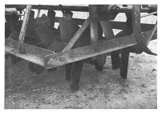
Fig. 14: Herse à bêches pourvue de nouvelles lames, de longueur suffisante, fixées par soudage.
