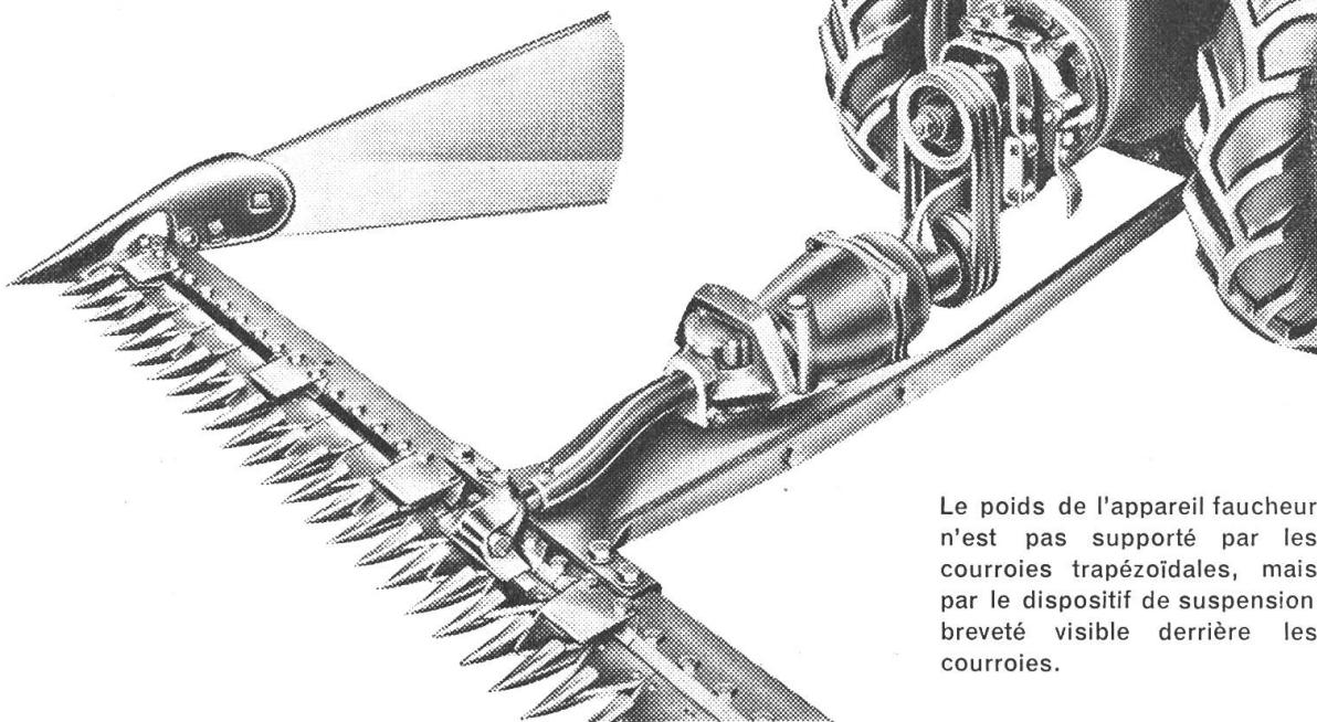
Le poids de l'appareil faucheur n'est pas supporté par les courroies trapézoïdales, mais par le dispositif de suspension breveté visible derrière les courroies.
