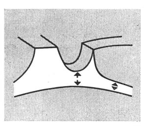
Une base solidement arc-boutée empêche le fléchissement et la compression excessifs des barres de traction et, partant, le rebondissement par leur sommet.
