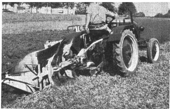
8 Tracteur Allgaier avec charrue Eberhardt. La charrue est utilisée avec un soc. On peut adapter un deuxième soc pour le déchaumage. Les deux roues porteuses fixées sur l'âge sont bien visibles.
