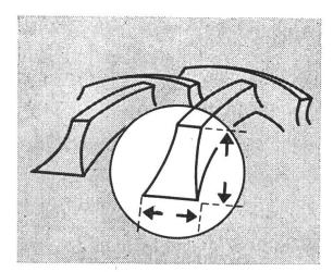
Les épaulements massifs et robustes réalisent un contact optimum entre la bande de roulement et le sol et l'adhérence s'en trouve améliorée. L'usure est uniforme et la durée est plus longue.
