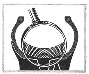
Double nappe protectrice contre les chocs. Deux nappes en textile spécial résistent aux chocs les plus forts et protègent efficacement la structure «corde» sous-jacente.
