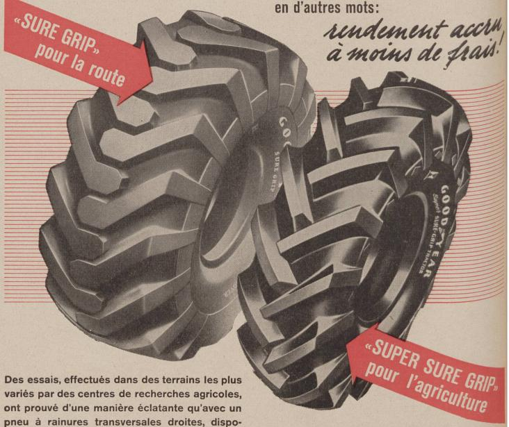
pneu à rainures transversales droites, disposées en forme de cône et interrompues au milieu, on obtient - et de loin - le meilleur pouvoir de traction, car il se nettoie de lui-même.
