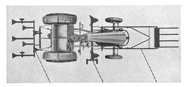
Fig. 9: Tracteur allemand caractéristique, «type B» (Hanomag R 12), avec système Combitrac. Fixation des outils devant, au milieu et derrière.
