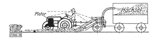
Fig. 4a: Faucheuse-hacheuse-chargeuse (USA et Allemagne).
