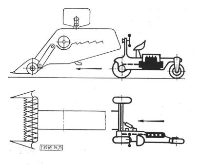
Fig. 6a et 6b: Moissonneuse-batteuse US (M.M.) poussée par bâti automoteur spécial à 3 roues.
