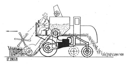
Fig. 5b: Moissonneuse-batteuse US montée sur châssis automoteur et allant en marche arrière (modèle IHC, jusqu'en 1952).
