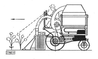
Fig. 5c: Récolteuse de coton US, montée sur tracteur ordinaire allant en marche arrière (modèle IHC).
