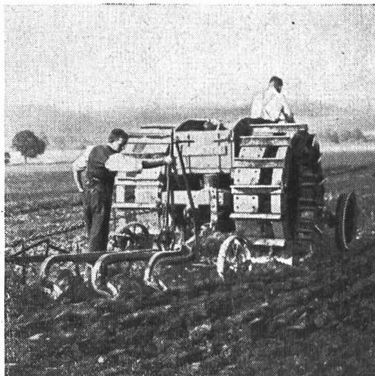
34 a et 34 b Afin d'éviter l'embourbement, des «roues» supplémentaires furent montées pour augmenter la surface de contact.
