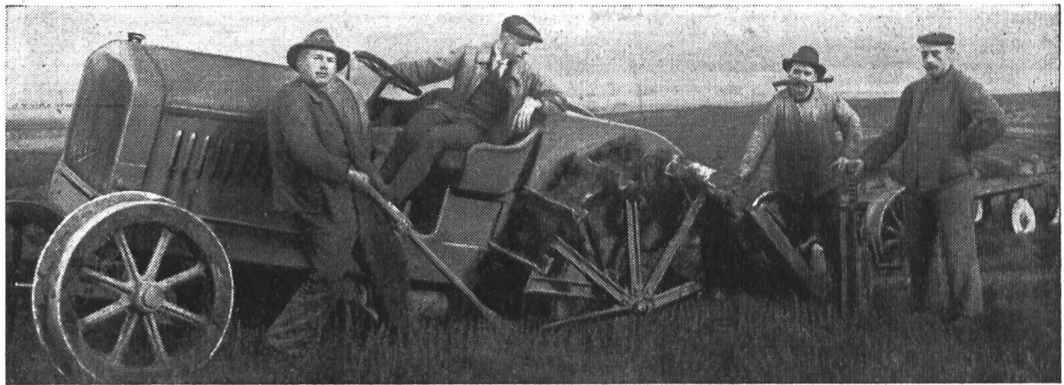
21 Tracteur Berna sur terrain très mou. Jusqu'à ce que des «roues» supplémentaires (pour augmenter la surface de contact des roues ordinaires) eussent été montées, le tracteur s'embourbait plusieurs fois par jour, ainsi que le montre la photo. Ce champ est situé à côté de l'aérodrome de Kloten.
