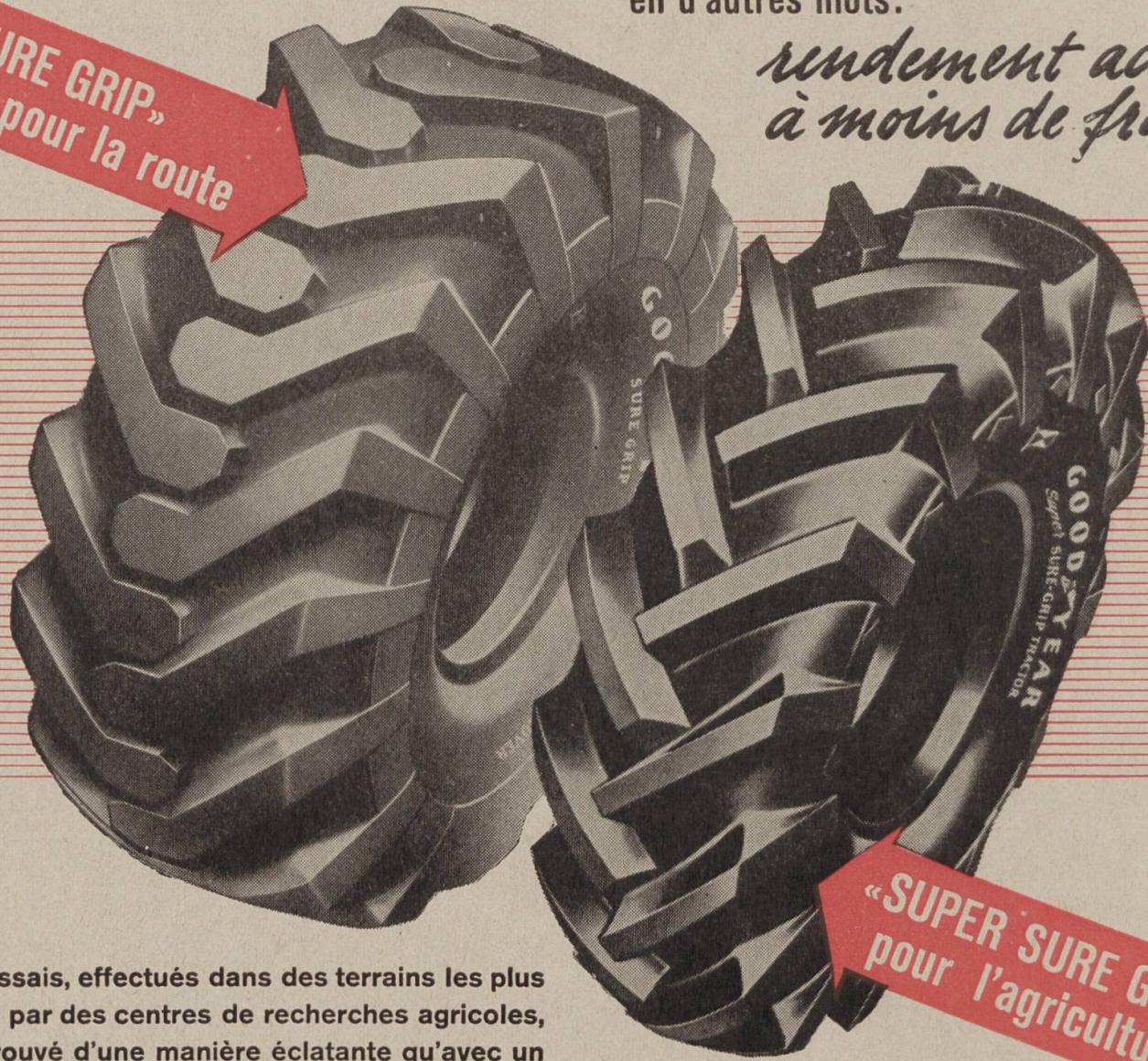
Des essais, effectués dans des terrains les plus variés par des centres de recherches agricoles, ont prouvé d'une manière éclatante qu'avec un pneu à rainures transversales droites, disposées en forme de cône et interrompues au milieu, on obtient — et de loin — le meilleur pouvoir de traction, car il se nettoie de lui-même.
