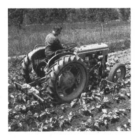
A gauche: Binage avec outils arrière manœuvrés par un auxiliaire.
