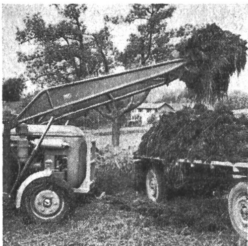
A gauche: Chargement de fumier avec élévateur frontal, système Wittenburg. A droite: Chargement de foin avec élévateur frontal, système Wittenburg.
