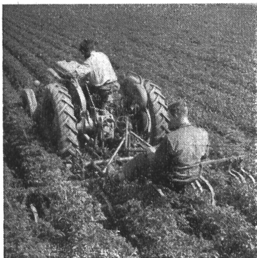
A gauche: Binage avec outils arrière manœuvrés par un auxiliaire. A droite: Binage avec outil fixé sous le tracteur.
