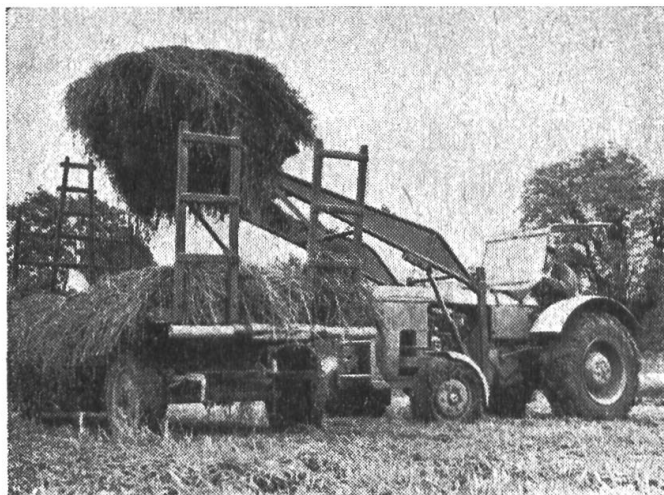
A gauche: Chargement de fumier avec élévateur frontal, système Wittenburg. A droite: Chargement de foin avec élévateur frontal, système Wittenburg.
