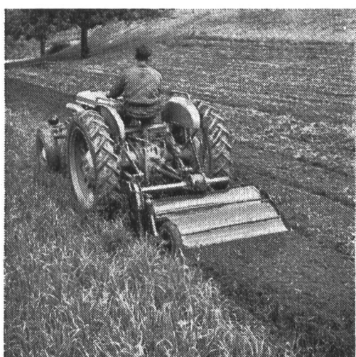
A gauche: Fraisage avec le Rotovator, largeur 135 cm, profondeur jusqu'à 20 cm. A droite: Tracteur Vevey 560 actionnant une fraise à lames Rotovator; largeur de fraisage 180 cm, profondeur jusqu'à 30 cm et plus.
