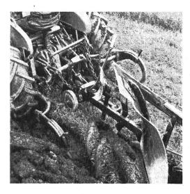
A gauche: Griffes sous-soleuses travaillant alternativement jusqu'à 30 cm de profondeur depuis le fond du sillon. La profondeur du travail est limitée par une chaîne réglable. L'inclinaison de l'outil est également réglable. Le relevage se fait en même temps que celui de la charrue, ou à main si la charrue n'est pas portée ou semi-portée. Pour lutter contre le tassement superficiel, les griffes sous-soleuses sont remplacées par des griffes fouilleuses.
