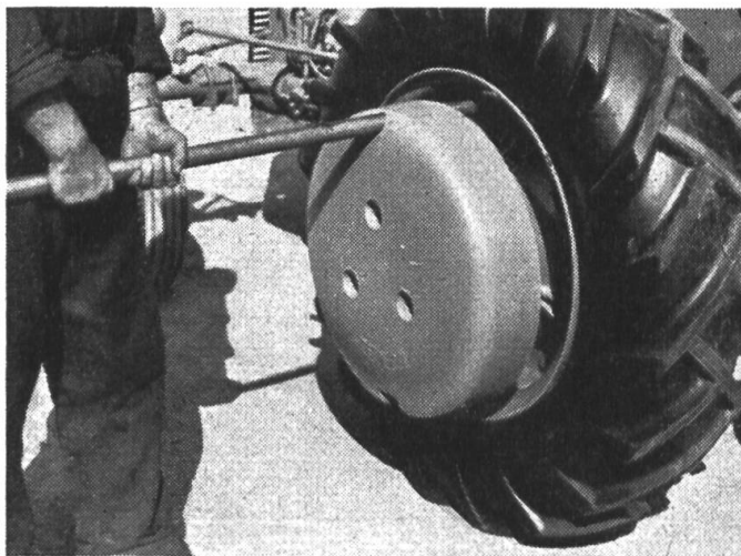
A gauche: Montage rapide d'un élément alourdisseur de 200 kg. A droite: Labourage, hersage et sous-solage simultanés.
