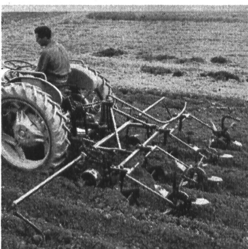
A gauche: Mise en place d'une barre de sarclage sous le tracteur. Le chariot de manœuvre est fixé à la barre au moyen de deux chevilles. La mise en place de tout le dispositif, y compris les supports au tracteur et le vérin hydraulique est exécutée par un seul homme en 4 minutes environ. A droite: Binage avec outils arrière, rigides latéralement.
