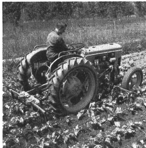
A gauche: Binage avec outils arrière manœuvrés par un auxiliaire. A droite: Binage avec outil fixé sous le tracteur.
