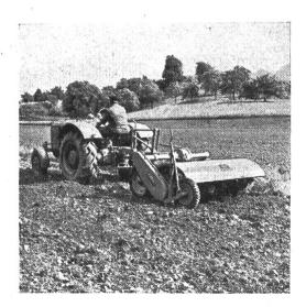
A gauche: Fraisage avec le Rotovator, largeur 135 cm, profondeur jusqu'à 20 cm.
