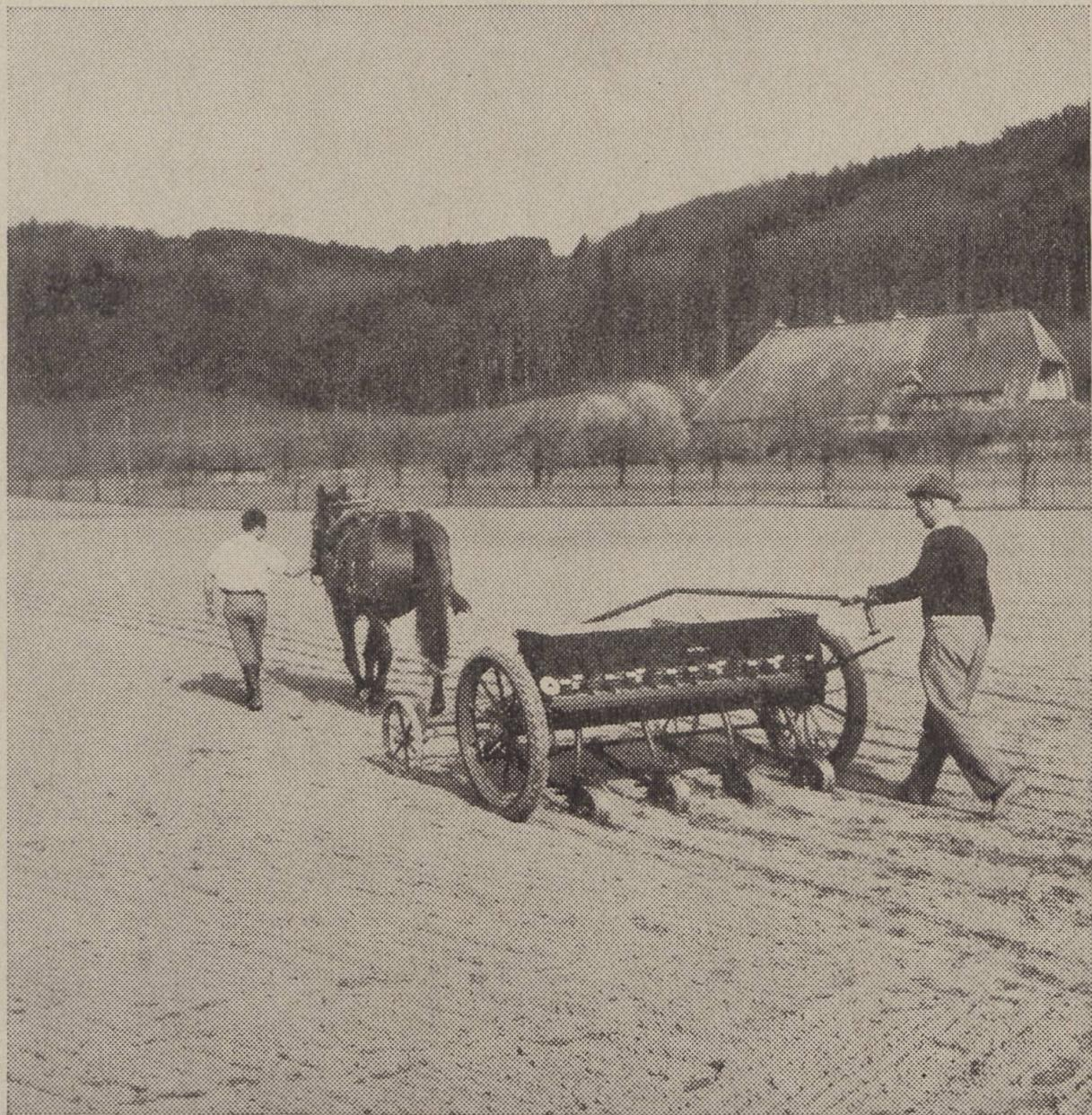
On sème les monogermes de betteraves de plus en plus avec le semoir AEBI: les semis sont suffisamment clairsemés et la levée est assez régulière pour permettre le démarriage selon la nouvelle méthode danoise. La photographie montre la machine de 2 m de largeur avec avant-train, roues à pneus, 4 socs à contre-poids (distance entre les lignes 50 cm) et rouleaux de pression.
