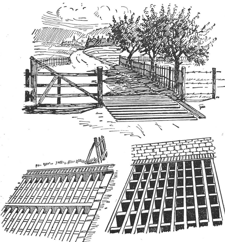
Les illustrations ci-contre fournissent quelques exemples de ces claires-voies. La fig. 1 montre un passage fait de tuyaux de fer soutenus dans leur milieu. On peut voir à la fig. 2 l'utilisation de rondins supportés par des traverses. La fig. 3 présente une claire-voie composée de madriers assemblée par entailles.
