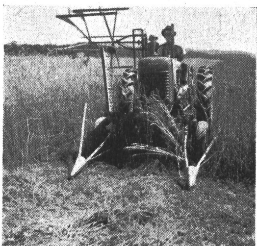
Fig. 1: Diviseur frontal adapté à l'essieu d'un tracteur.
