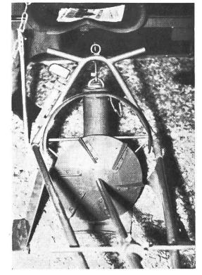
Fig. 1 Instrument à 1 ligne pour le démariage des betteraves par hachage.
