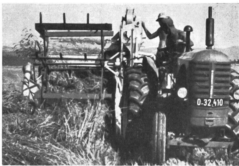
Fig. 6 Moissonneuse-batteuse dans du blé versé. Constructeur: Epple-Buxbaum SA, Wels (Autriche).
