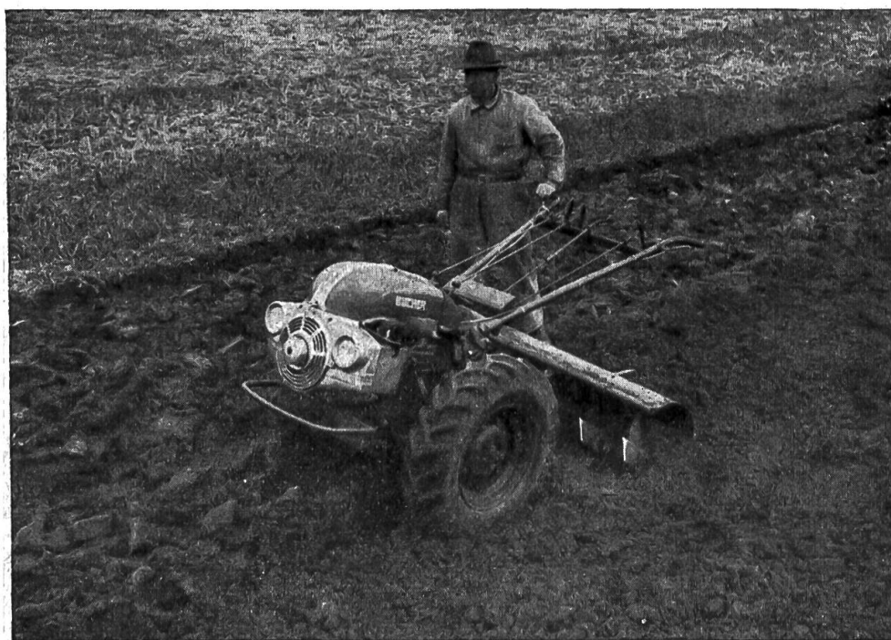
Fig. 1. Herse rotative à prise de mouvement accouplée à tracteur à 1 essieu.
