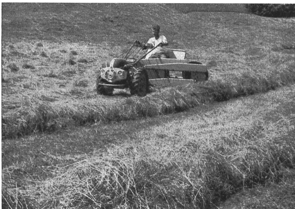
Fig. 4. Râteau à andains à prise de mouvement, accouplé à tracteur à 1 essieu.
