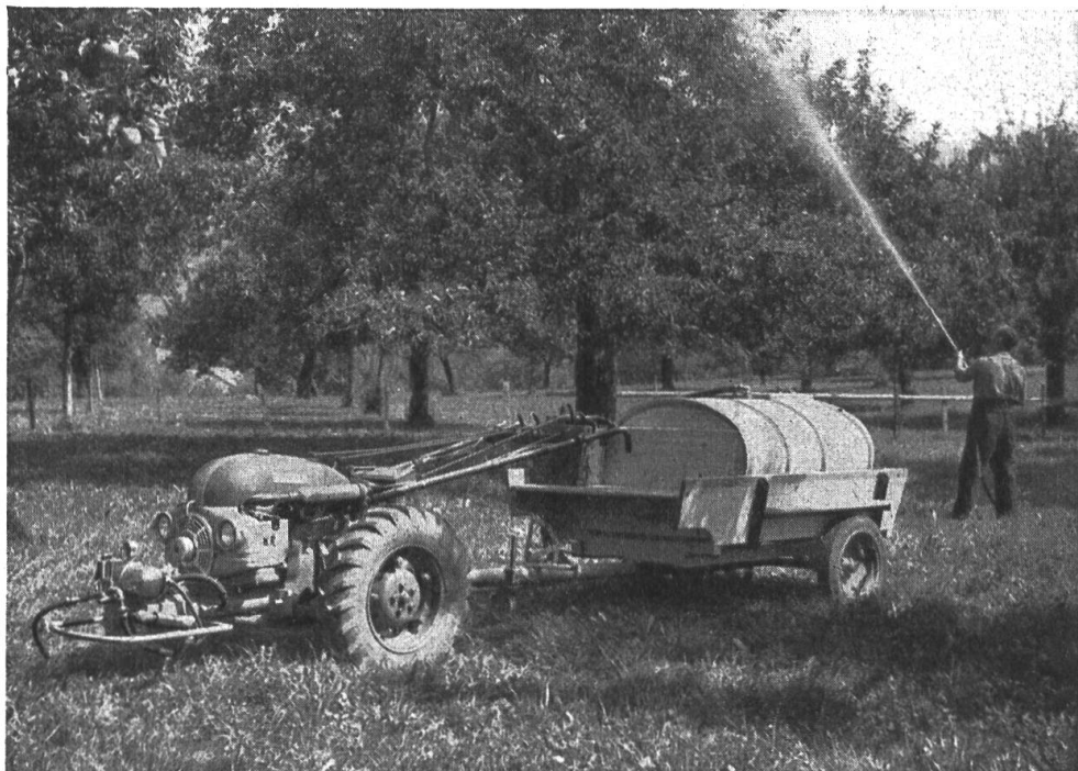
Fig. 3. Pulvérisateur accouplé à tracteur à 1 essieu.
