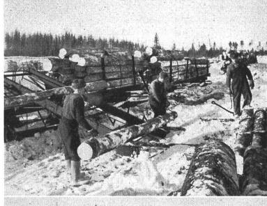
Convoi de traîneaux en route vers le lac le plus proche. Ce train routier se compose de 6 à 8 traîneaux doubles. Capacité de chargement: 180 m<sup>3</sup>.
