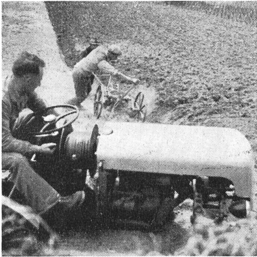
Fig. 4 a: Traction au câble, perpendiculairement au tracteur.
