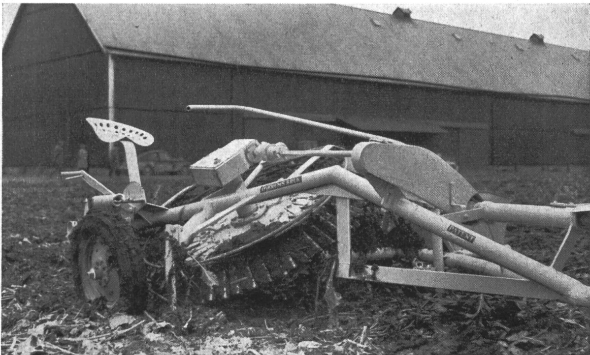
Fig. 2: Arracheuse à betteraves à 1 ligne «Kaller» actionnée par la prise de mouvement,
