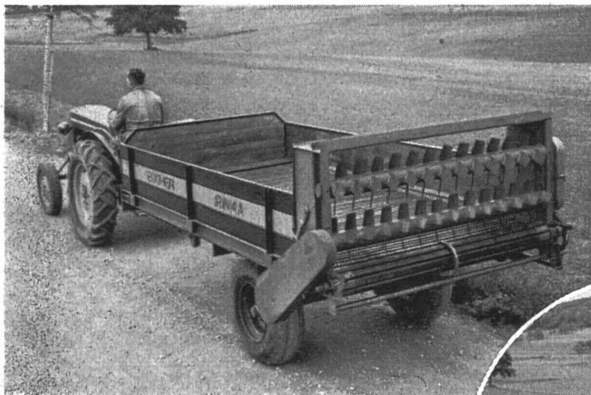
Fig. 7 Epandeuse automatique «Oekonom-Rinka». (Cliché: Maison Bucher-Guyer, Niederweningen)
