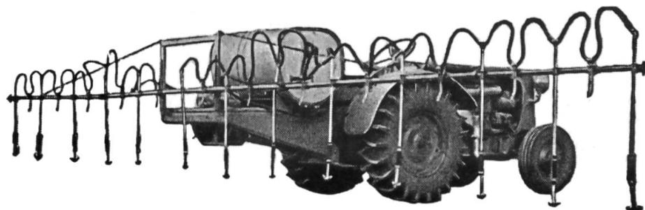
Par la suppression de l'essieu, des freins, des roues et pneus, le pulvérisateur porté HARUWY, monté sur tracteur, est très maniable. La grande garde au sol sous cet appareil permet de braquer très court au bord du champ sans endommager les cultures. L'entrainement de la pompe se fait par la prise de mouvement ce qui évite l'achat d'un moteur. Grâce à toutes ces simplifications, le pulvérisateur porté HARUWY est le meilleur marché à l'achat et à l'emploi.
