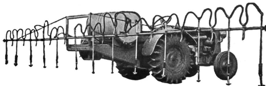
Par la suppression de l'essieu, des freins, des roues et pneus, le pulvérisateur porté HARUWY, monté sur tracteur, est très maniable. La grande garde au sol sous cet appareil permet de braquer très court au bord du champ sans endommager les cultures. L'entrainement de la pompe se fait par la prise de mouvement ce qui évite l'achat d'un moteur. Grâce à toutes ces simplifications, le pulvérisateur porté HARUWY est le meilleur marché à l'achat et à l'emploi.
