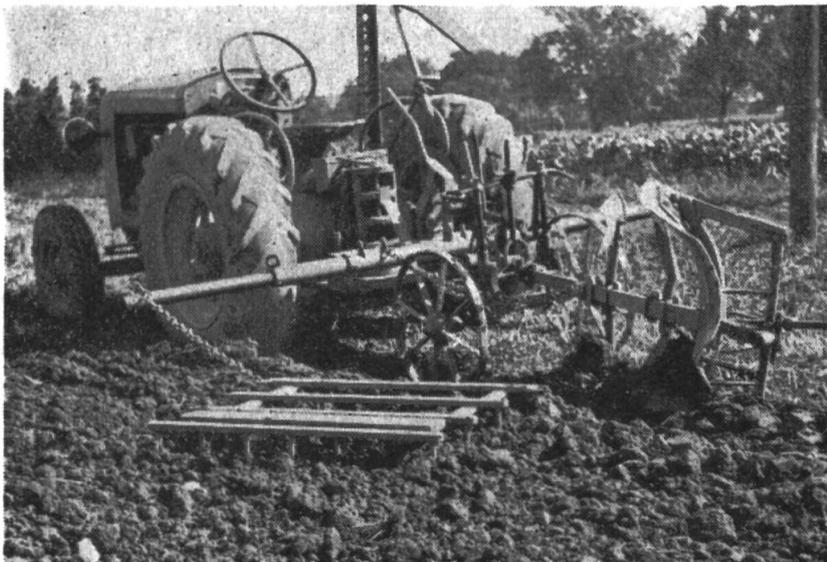
**Appréciation générale:** Le dispositif d'attelage au tracteur pour charrue Brabant et herse a fait ses preuves pendant les essais. La construction est simple et solide.
