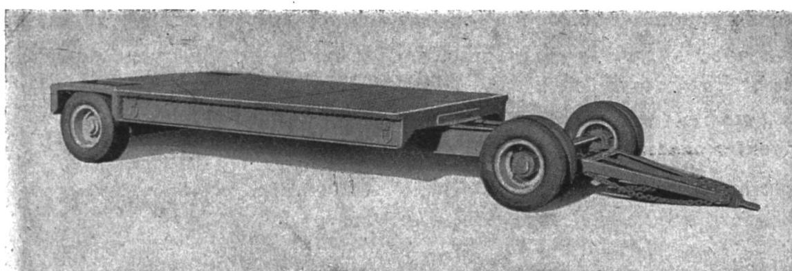
La Figure 3 représente une remorque à pont très bas (Moser, Berne) pour une charge utile de 20 tonnes, utilisée plus spécialement pour le trans-
