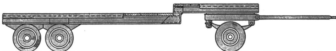
La Figure 2 représente une remorque à pont bas (Moser, Berne) pour une charge utile de 15-20 tonnes, employée surtout pour le transport de machines de construction. Etant pourvue de ponts de chargement plats et bas, la structure de cette remorque répond ainsi aux exigences de divers transports.
