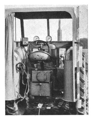
Fig. 4: Cabine du conducteur du véhicule à freins avec appareils de mesurage.
