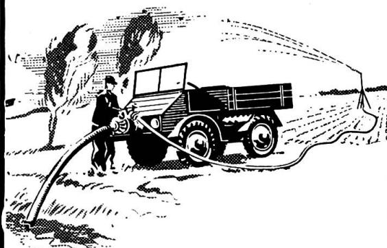
La pompe actionnée par la prise de mouvement avant débite 800 lt/min.
