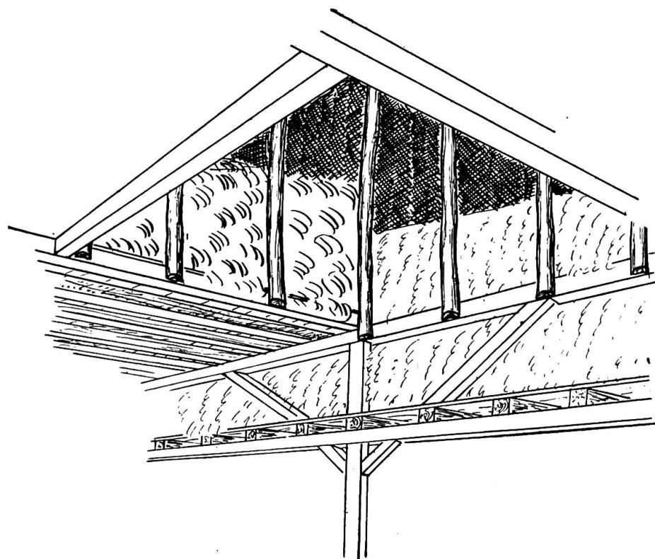
Il faut fixer des lattes verticales suffisamment solides au bord des tas pour éviter des chutes. La distance entre deux lattes sera de 80-100 cm de façon qu'elles ne constituent pas un obstacle pour le travail.
