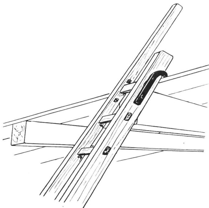
Les échelles mobiles qui conduisent sur les hauts lieux doivent être munies d'un crochet de sécurité.
