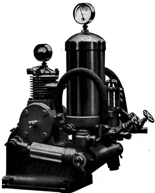
destiné au montage sur toutes machines motorisées telles que tracteurs, motoculteurs, motofaucheuses, mototreuils et tous les moteurs indépendants.
